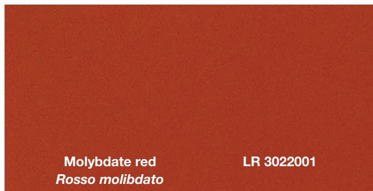
Fig. 7 Confronto del colore a tinta piena del rosso molibdato (a sinistra) e di “LR 3022001” (a destra) su pannello di contrasto bianco/nero (2C-acrilica; pigmentazione al 20%)
