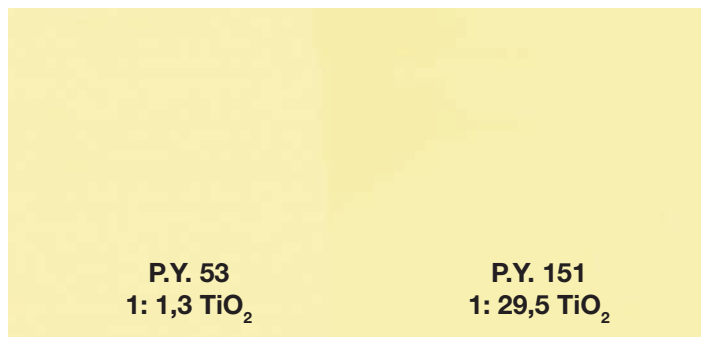
Fig. 2 Tenacità cromatica del giallo nichel rutilo P.Y. 53 confrontato con P.Y. 151. Per la regolazione alla profondità del colore standard 1/3 SD, si richiede una quantità inferiore di prodotto organico P.Y. 151
